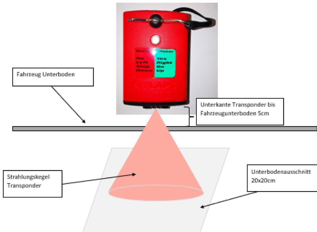
Direkt unter dem Transponder muss ein Loch 20x20cm in der Bodenplatte ausgeschnitten werden.
