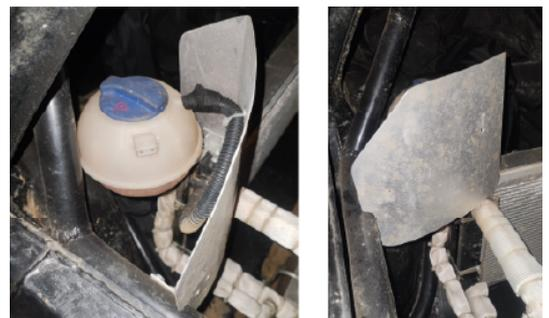
*Minimalster Spritzschutz für Ausgleichsbehälter (mehr ist empfohlen)*
